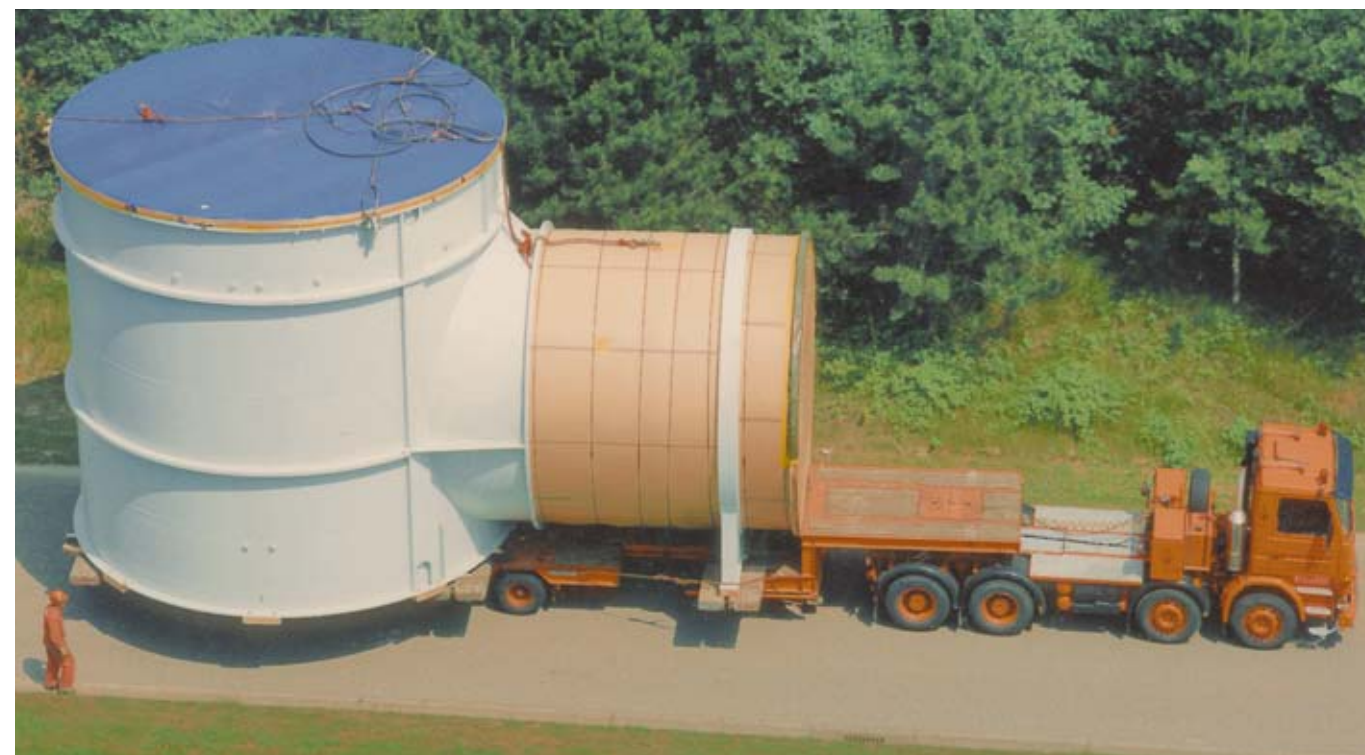
Abtransport eines Kaminunterteils, ABB GT 13 D
