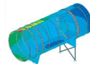
Finite Element Analyse eines Abgassystems
