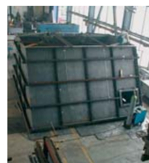
Herstellung eines Abgas-Übergangsstücks, GE MS 7001 FA
