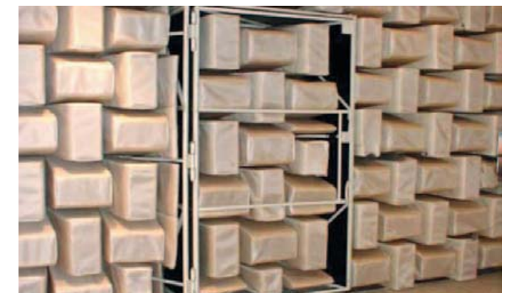
Reflexionsarmer Raum Landesamt f. Umwelt in Essen; ASONAD-MF Keile (Gewebeüberzug), f_g = 100 \text{ Hz} , L \times B \times H = 5,8 \times 5,0 \times 4,7 \text{ m}
