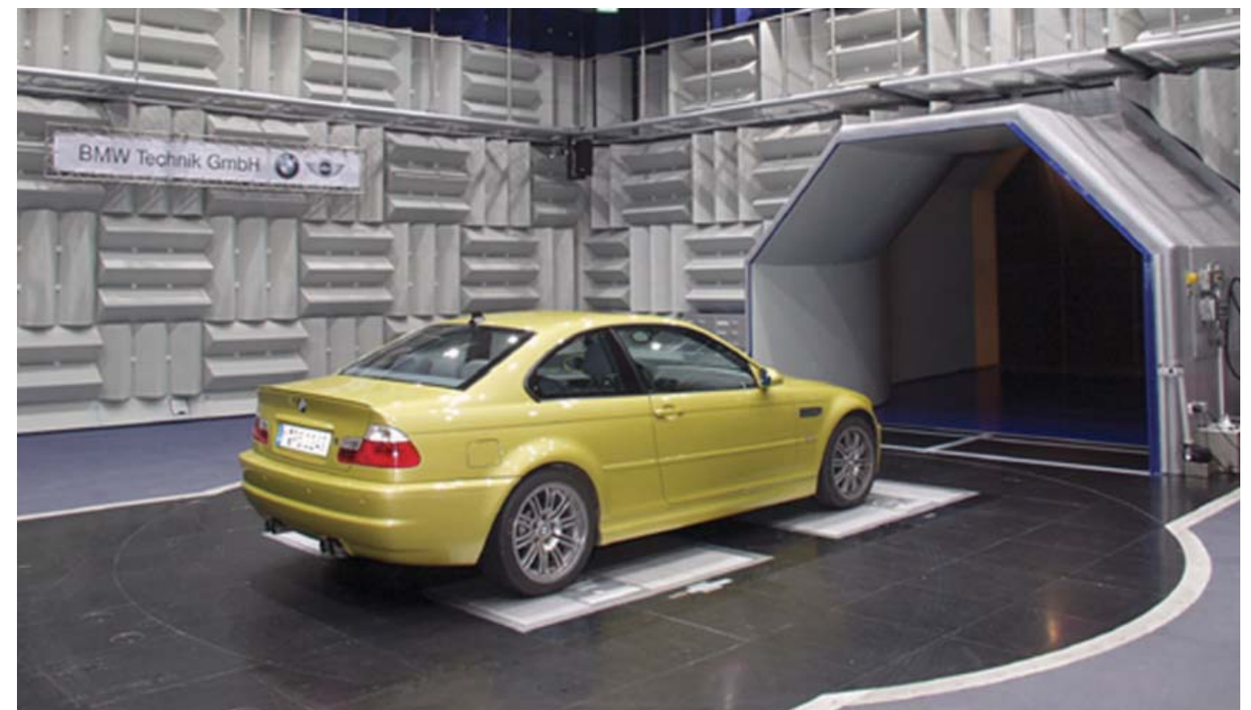
Reflexionsarm ausgekleideter Windkanal mit farbbeschichteten ASONAD-ML Keilen (mit Lochblechabdeckung)
