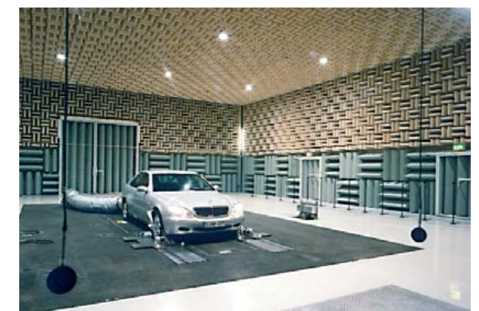
DaimlerChrysler Entwicklungszentrum Sindelfingen f_g = 80 Hz; 22 x 18 x 6 m Keile unten mit Lochblechabdeckung, oben mit Gewebeüberzug.
